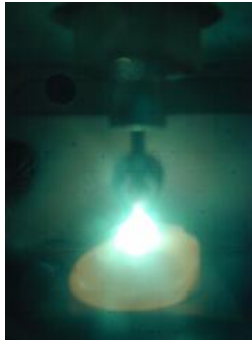
Fonte par arc électrique à 1800 °C
