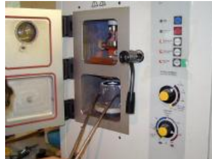
Cylindre mis en place pour la coulée
